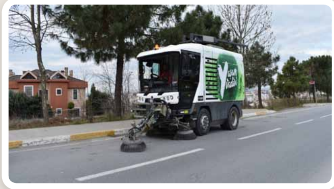
▼ BETON VE HER NEVİ ASFALT YOLLARIN MAKİNE İLE SÜPÜRÜLMESİ • ÇEVRE KORUMA VE KONTROL MD.
